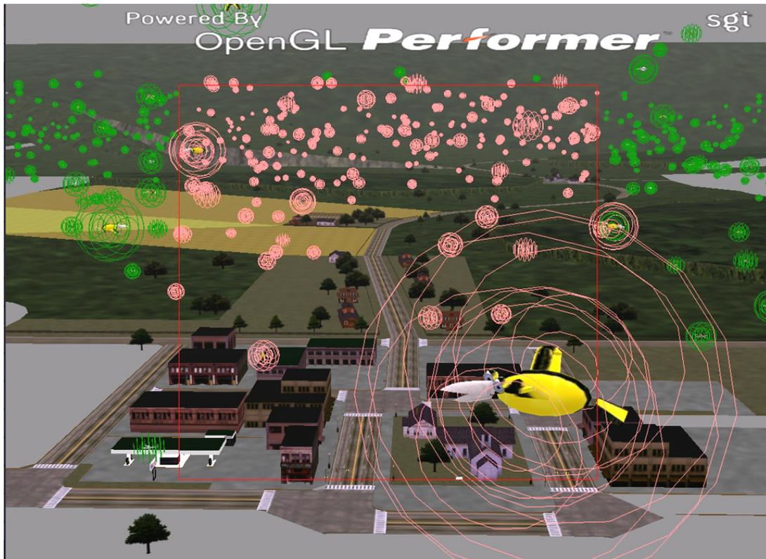
**Figura 9-17.** Modo de visualización de las *bounding spheres* de los actores en la simulación.
