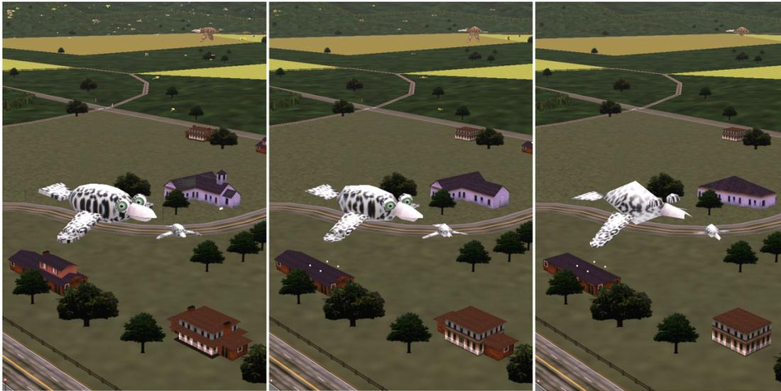
**Figura 9-14. Utilización del factor modulación del nivel de detalle para reducir la calidad de la imagen (y disminuir el tiempo de dibujado).**
