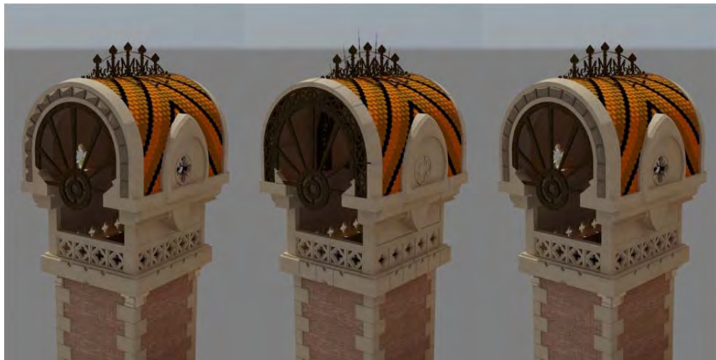
II-lustració 122. Formalització C1: diamant, biga de gelosia i pedra al bisell.
