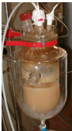
Figura 4.5.- Montaje experimental para acondicionar el fango de depuradora.
