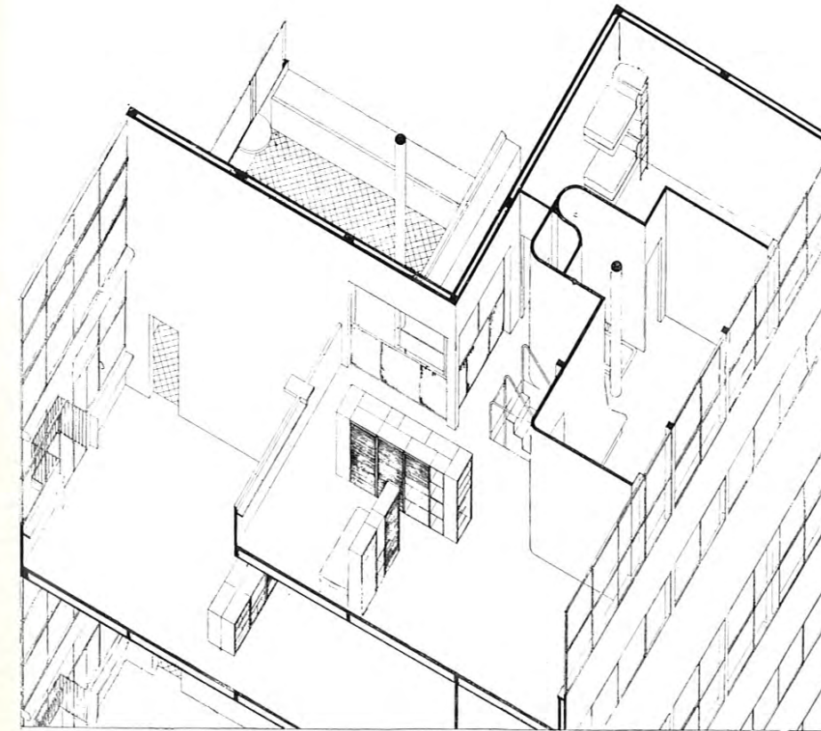
Axonometrische Perspektive eines Villenelements, Standardisierung aller Konstruktionselemente
