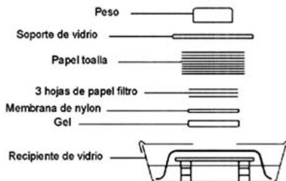
Figura III.12: Representación esquemática de la construcción para la transferencia por capilaridad del gel de agarosa a la membrana Hybond-N + .
