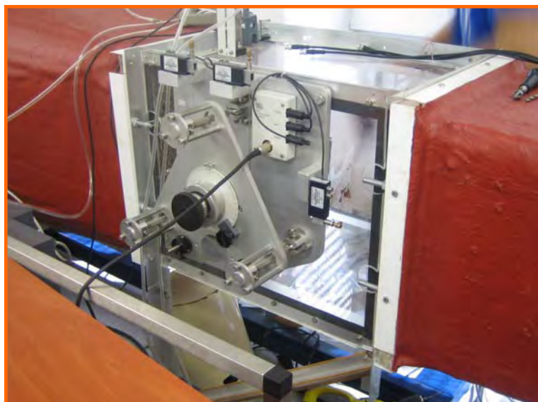
Figura A71. Detalle del sensor electrónico del túnel de viento que se conecta al ordenador.
