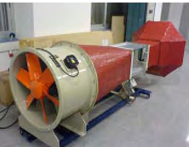
Figura A63. Ventilador del túnel Ø 80cm.
