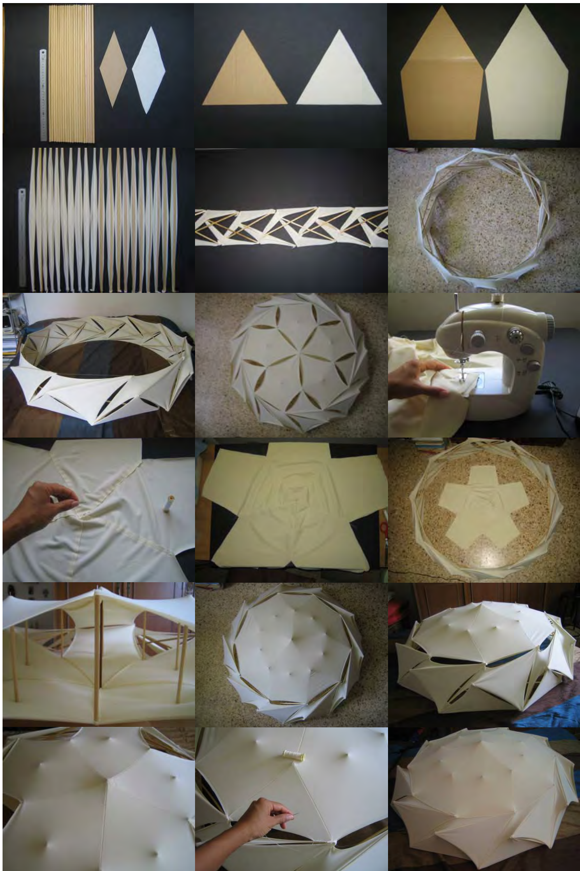
Figura 85. Tipología No. 4 - Proceso constructivo de modelo tensegrity Ø 100 cm. Esc_1:100
