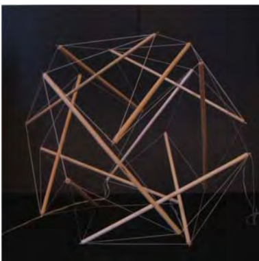
Figura 62. Modelo tensegrity triple capa vista en alzado.
