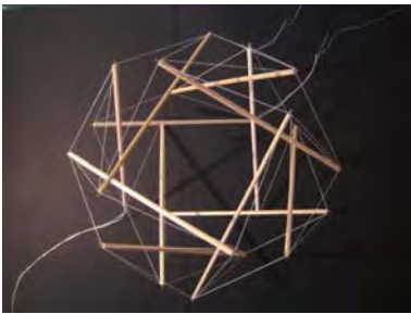
Figura 61. Modelo tensegrity triple capa vista en planta.
