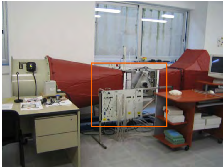
Figura A70. Sensor electrónico del túnel de viento que se conecta al ordenador.
