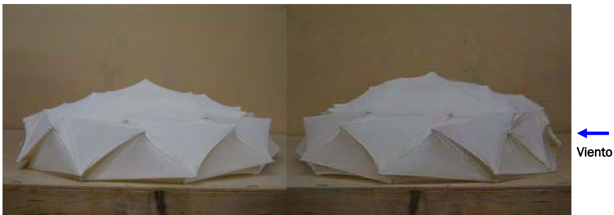
Figura A94. Efectos del viento en el modelo físico de \varnothing 100cm ante una velocidad de 70km/h.
