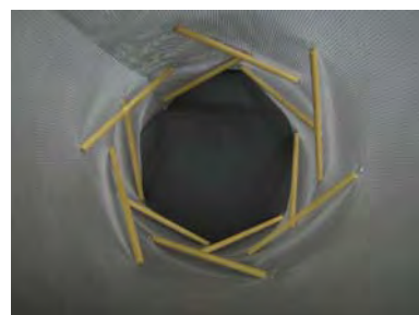
Figura 71. Modelo tensegrity, patrón de malla plástica. Esc_1:100 Barra L= 20cm – malla 60cm x 20cm – red de puntos 5x5cm.
