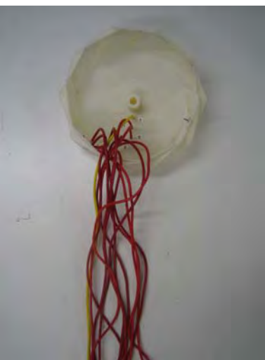
Figura A69. Tomas de aire sondas S 1 a S 13 .
