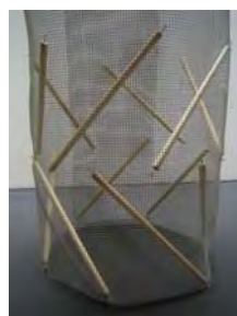
Figura 71. Modelo tensegrity, patrón de malla plástica. Esc_1:100 Barra L= 20cm – malla 60cm x 20cm – red de puntos 5x5cm.
