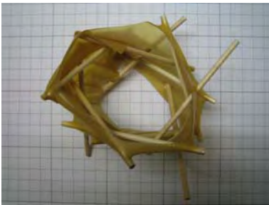
Figura 70. Modelo tensegrity en patrón de látex. Esc_1:100
