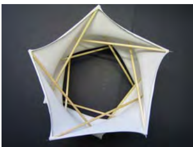
Figura 72. Modelo tensegrity en patrón de membrana textil - lycra. Esc_1:100
