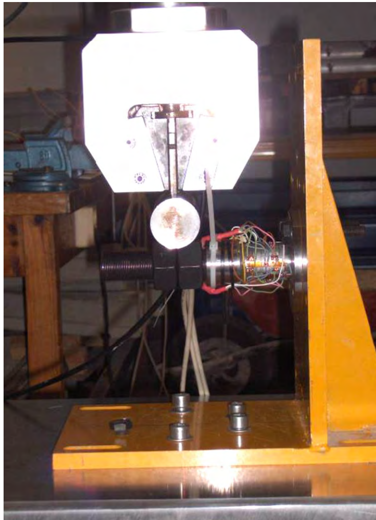
Figura 3-22: Calibració de moment flector i esforç tallant de les galgues extensomètriques
