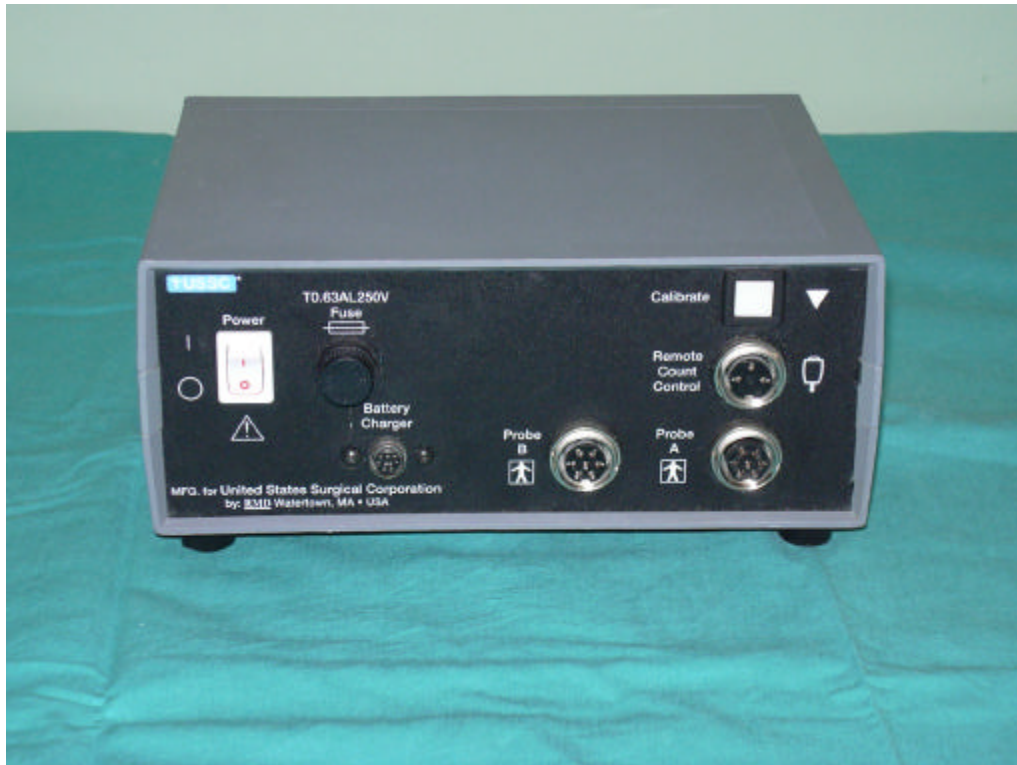
Figura 29: Unidad de control del sistema “NAVIGATOR* Gamma Guidance System”. Vista de su cara posterior
