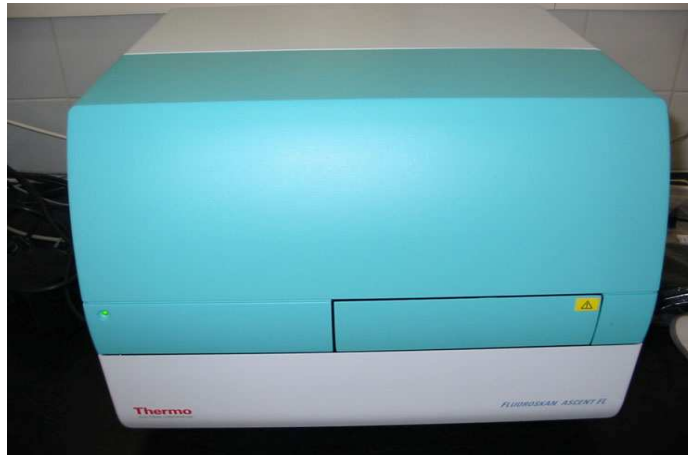
Figura 63. Fluorímetro Fluoroskan Ascent. Unidad de Investigación Oftalmológica “Santiago Grisolia” (Valencia).
