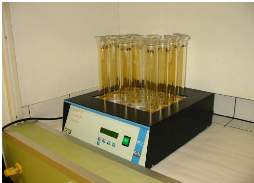
Foto 15.- Bloque digester DK20 Heating Digester utilizado para la digestión de las muestras de suelo (Método 1).
