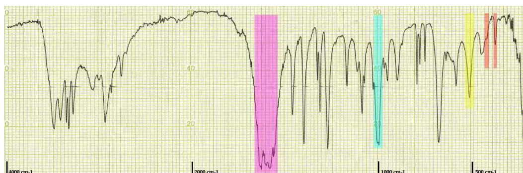
Figura 68. Espectre d'infraroig del compost [\text{Ni}(\text{5-clorouracilat-N}^1)_2(\text{en})_2] \cdot 2\text{H}_2\text{O} [33]. Hi hem marcat les bandes més representatives en colors segons la seva procedència: En rosa es marquen les bandes d'anell [ \nu\text{C}(2)=\text{O}+\nu\text{N}(1)-\text{C}(2) ] i [ \nu\text{C}(4)=\text{O}+\nu\text{C}(4)-\text{C}(5) ] del ClUra; en blau, la vibració \nu\text{C}-\text{C}/\nu\text{C}-\text{N} de l'etilendiamina; en groc, la vibració C-Cl; i en vermell les dues bandes \nu\text{Ni}-\text{N} .
