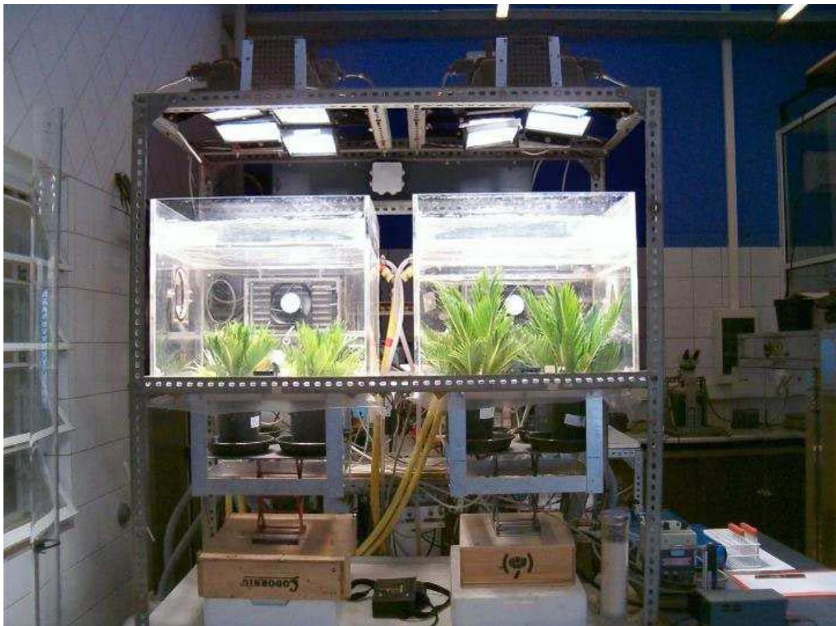
Figura 3.6.1. Imatge frontal de les cambres de mesura de bescanvi de gasos de la capçada amb plantes de Cycas revoluta a l'interior. La cambra de l'esquerra conté plantes cultivades a CO 2 ambiental i la cambra dreta plantes provinents de CO 2 elevat.
