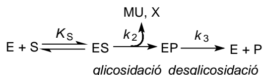
Figura 6.13. Mecanisme bàsic de retenció de configuració en dues etapes.
