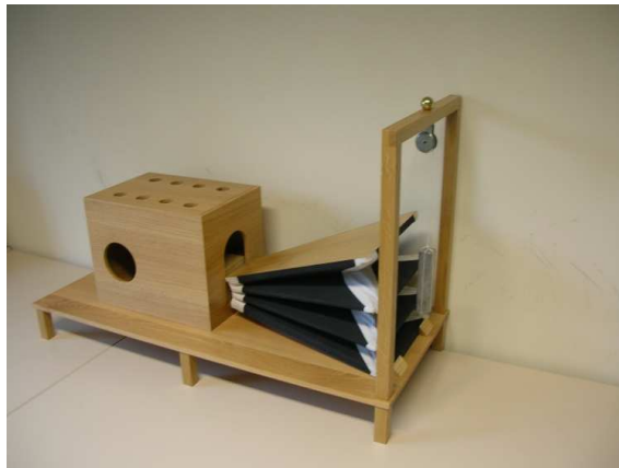
Figura 3.6: Reconstrucción de la máquina parlante de von Kempelen (1791) (Universitat des Saarlandes)
