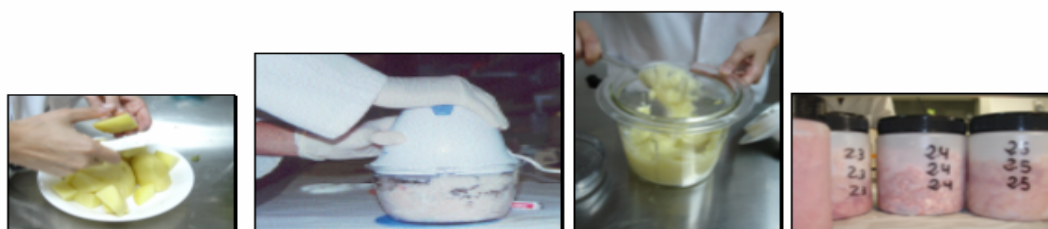
Figura 9. Procés d'homogeneïtzació de les mostres i formació dels “composites”.
