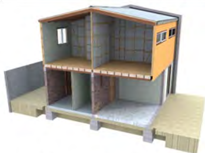
Sistema constructivo de la vivienda social progresiva
