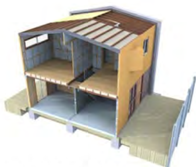
Sistema constructivo de la vivienda social progresiva
