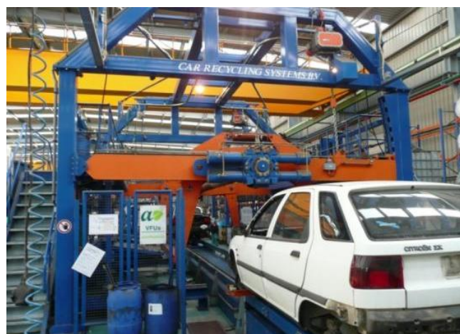
Figura 21. Entrada de vehículo al final de su vida útil al volteador (cortesía de D. Luís Espiñeira)
