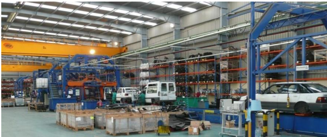
Figura 20. Cadena de desmontaje de VFUs Armonía Galicia (cortesía de D. Luís Espiñeira)
