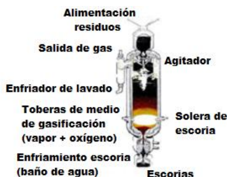
Figura 43. Esquema de la tecnología BGL-G (Envirotherm GmbH, 2011)
