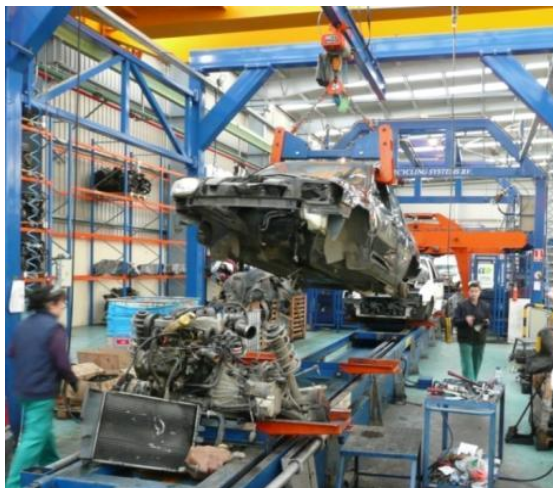
Figura 23. Extracción del radiador y motor completo tras el paso por el volteador (cortesía de D. Luís Espiñeira)
