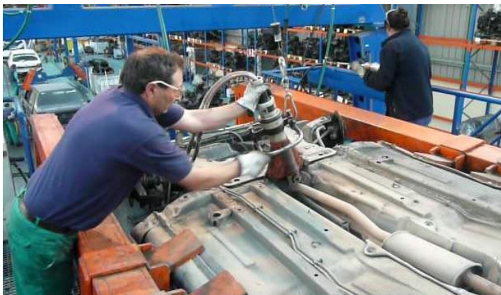
Figura 22. Extracción de un escape en el volteador (cortesía de D. Luís Espiñeira)
