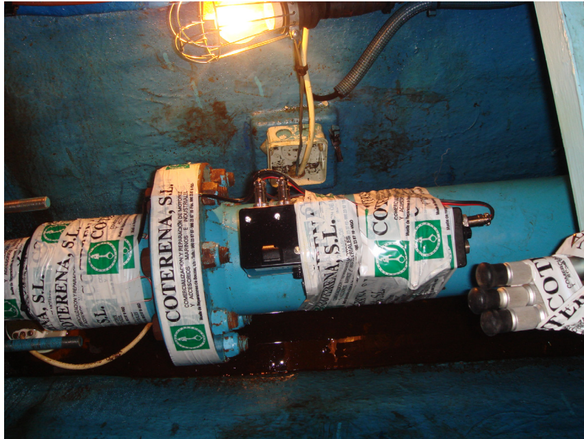
Torsiómetro montado en eje de cola
