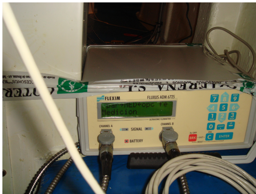
Caudalímetro ultrasonidos FLEXIM FLUXUS ADM 6725
