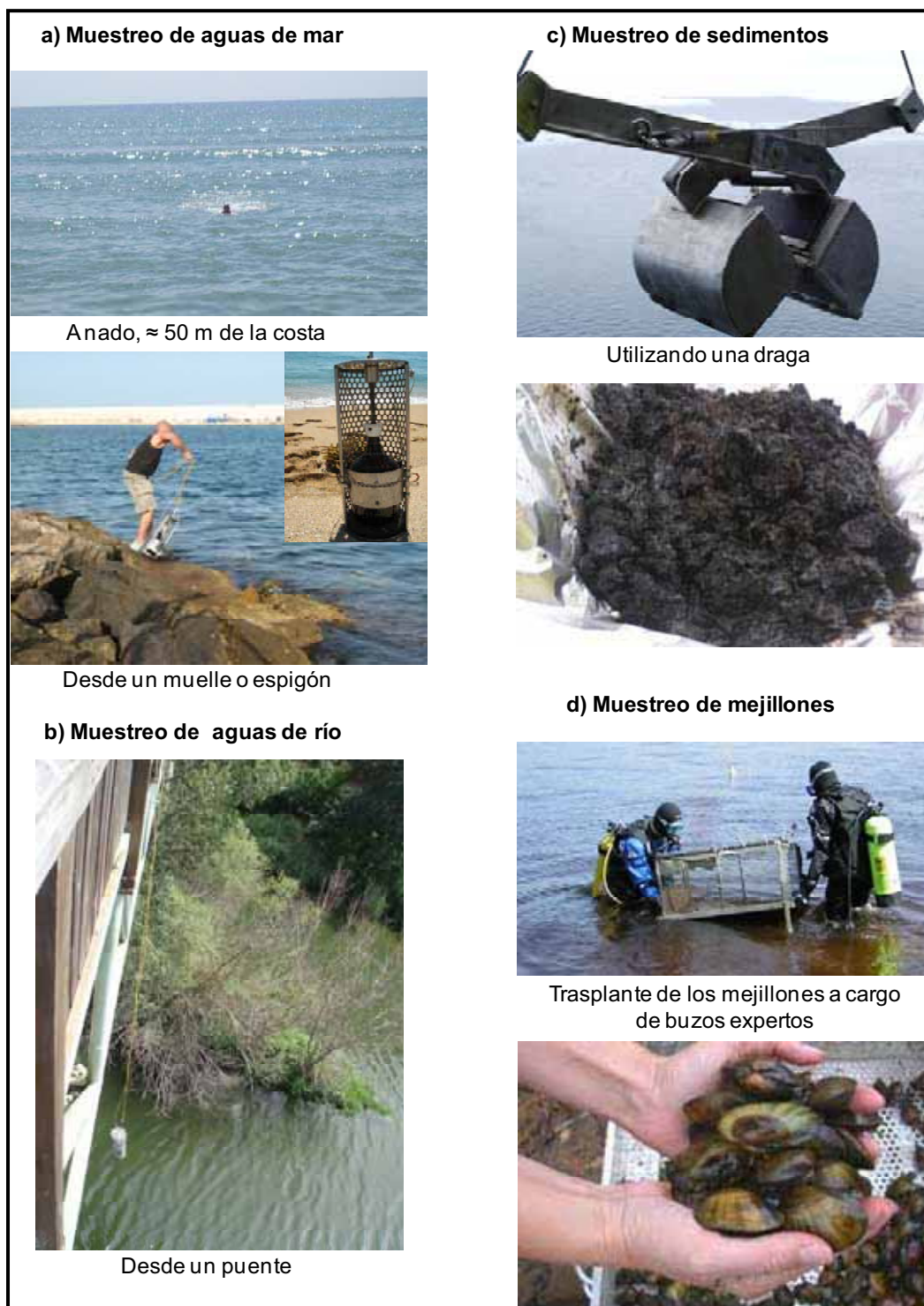
Figura 18. Imágenes de la toma de muestra de a) aguas de mar; b) aguas de río; c) sedimentos; d) mejillones trasplantados
