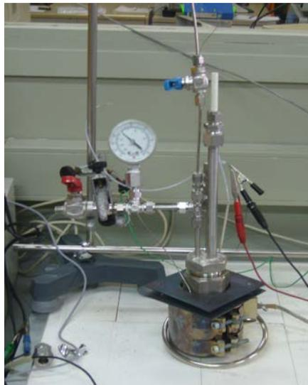
**Figura 4.2.14** Montaje del Diseño 2 para determinación de solubilidad de oxígeno en LBE
