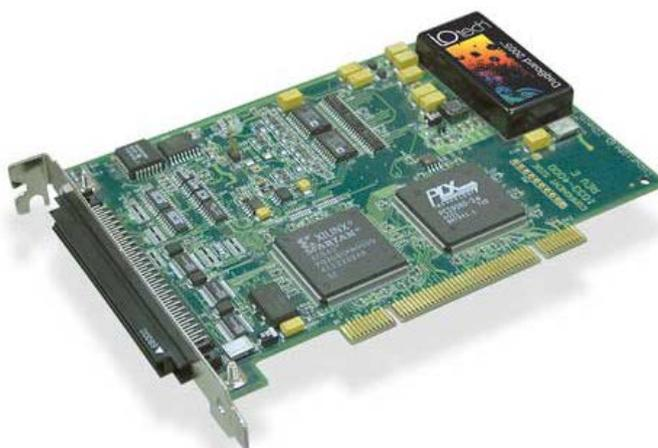
**Figura 4.1.7** Convertor analógico/digital DaqBoard 2000.
