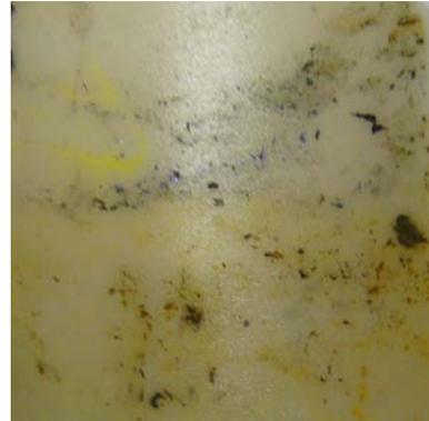
**Figura 4.2.16** LBE y la cara interna del crisol de YSZ una vez finalizado el experimento.
