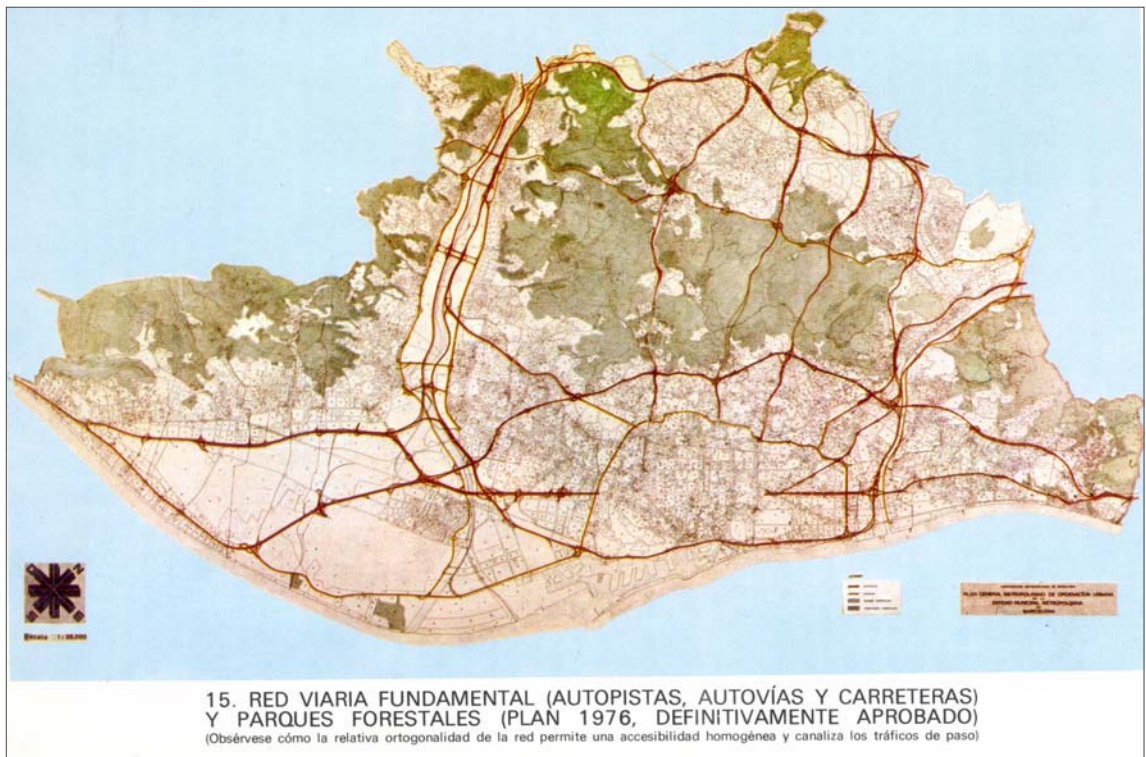
Foto n.34.- Esquema de la xarxa viària fonamental del Pla General Metropolità de 1976 (Serratos, 1979)
