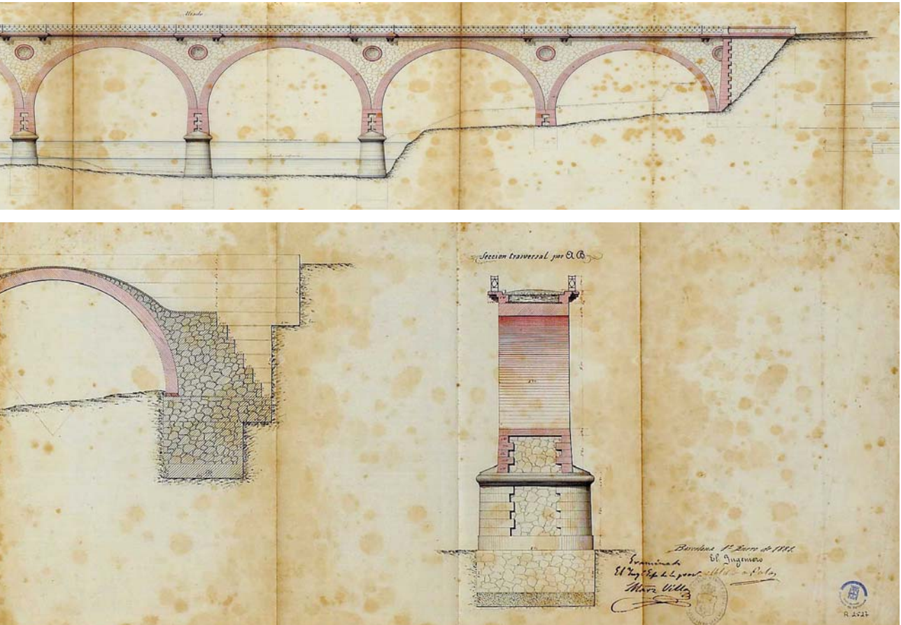
Fotos n. 116 i 117.- Projecte de pont sobre la riera de Lavernó en la carretera de Sant Boi de Llobregat a la Llacuna. 1881. Signat per Melchior de Palau. Escala 1:100 (AGDB, LI. 2114).
