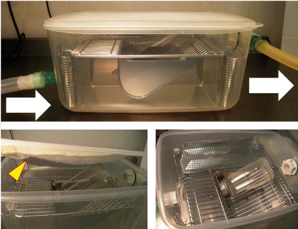
Figura 14. Gàbia dissenyada per a mantenir els ratolins en condicions d'hipòxia. Les fletxes blanques indiquen el sentit d'entrada i sortida dels gasos. La punta de fletxa groga assenyalava la ubicació de l'absorbent de CO 2 .
