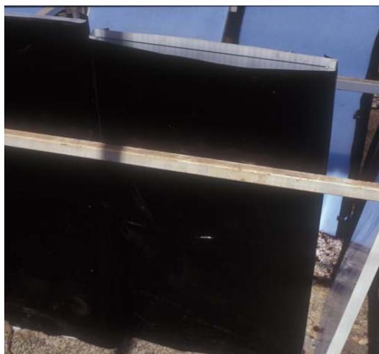
**Figura 2.1.** Detalle de un minirizotrófono largo. Su cara transparente está cubierta por un plástico negro. Está inclinado un ángulo de  $30^\circ$ .
