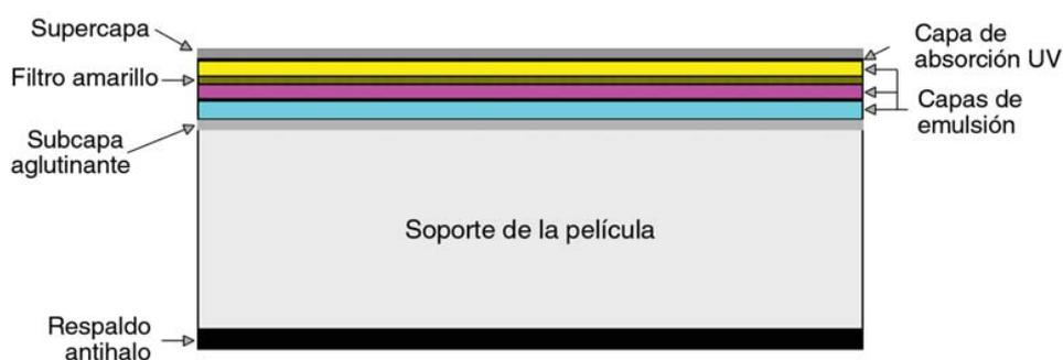
Figura 6. Estructura de la película (Kodak, 2010, p. 30)
