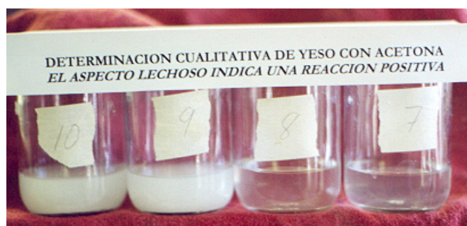
Figura II.7. Prueba cualitativa de la presencia de yeso, el precipitado blanco lechoso indica reacción positiva.
