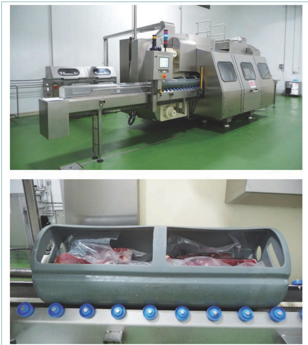
Figura 3. Procesado de muestras de jamón con altas presiones hidrostáticas.
