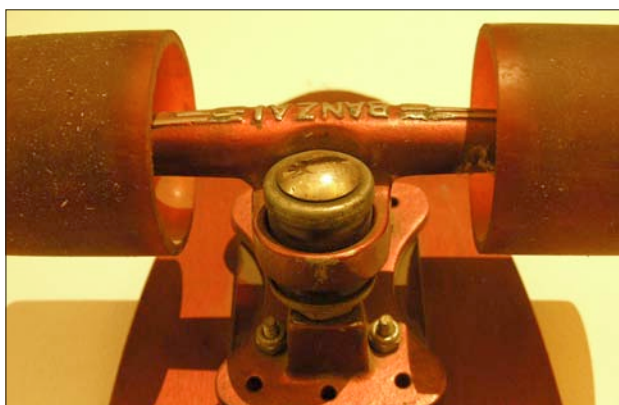
Ruedas de poliuretano y eje evolucionado de un monopatín de la década de 1970. Fotografía realizada en 2007. Fuente: X. Camino.
