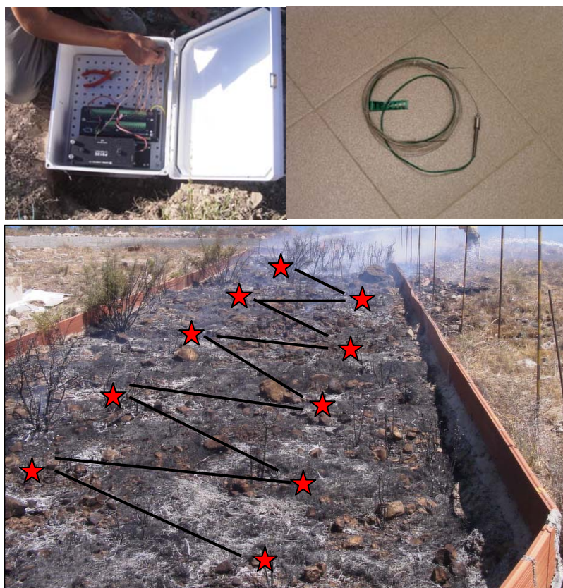
Foto 3.1.4_3. Detalle de datalogger y termopares utilizados en las quemas experimentales. Disposición utilizada en la quema del año 2003 en La Concordia.
