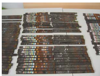
Foto 3.2.2_2. Detalle de pinturas termosensibles utilizadas en la quema controlada de Podentes.
