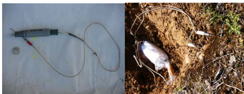
Foto 3.2.2_1. Termopar e instalación del mismo en la quema controlada de Podentes.
