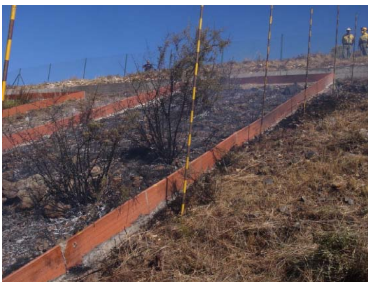
Foto 3.1.4_1. Detalle de cenizas y disposición de pértigas a lo largo de la parcela 4 en la quema experimental realizada en Julio del 2003 en La Concordia.
