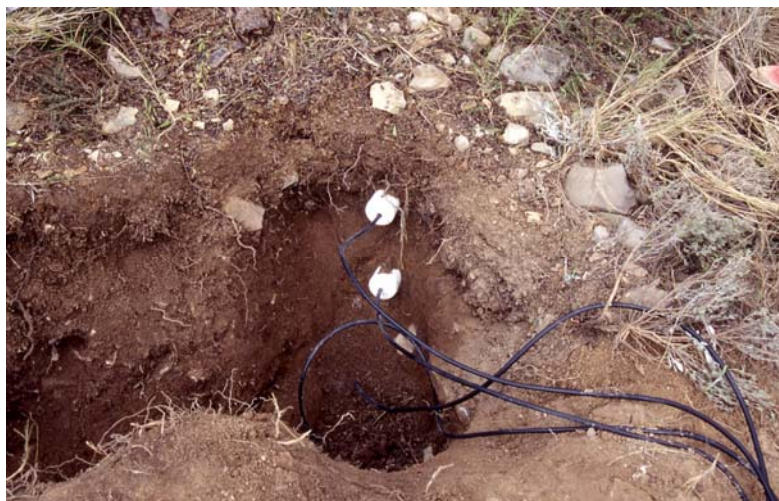
Foto 3.4_1. Sensores de humedad en el perfil del suelo de La Concordia.
