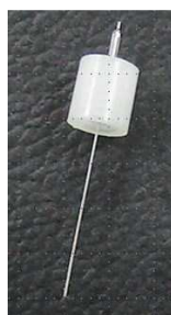
Figura 3.10: Inyector para microinyección.
