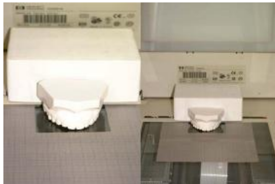
Figura 1: Orientación y digitalización de los modelos de estudio en el escáner en el Método Digital.
