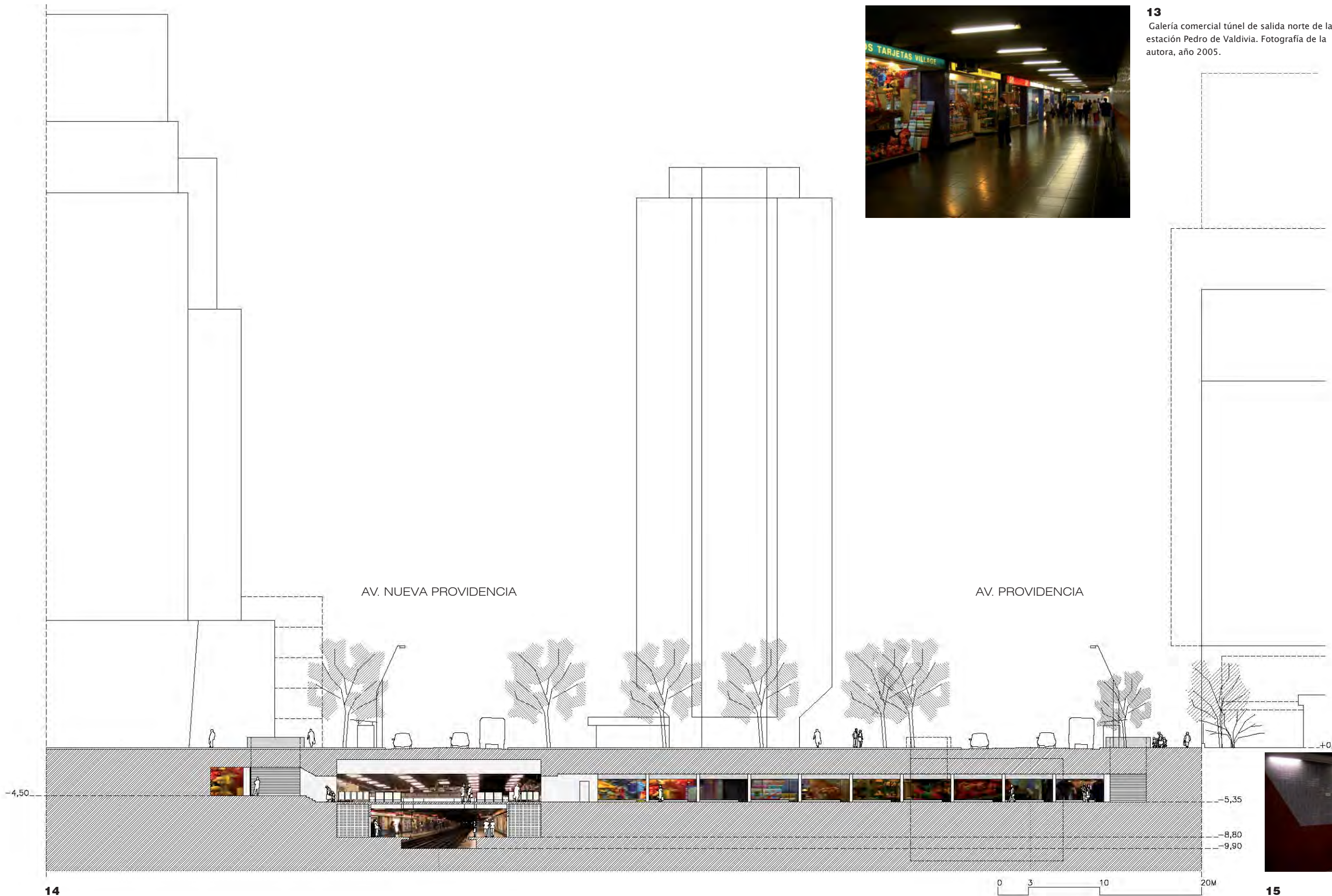
14 Pedro de Valdivia: sección transversal por la mezanine y galería comercial norte de la estación. Elaboración propia.
