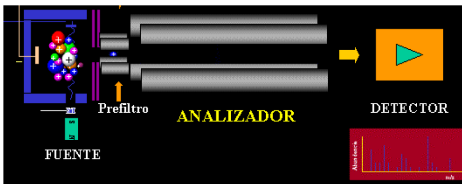
Figura 2.1.3.4.2. Esquema de l'anàlitzador de simple quadrupol (Waters™)
