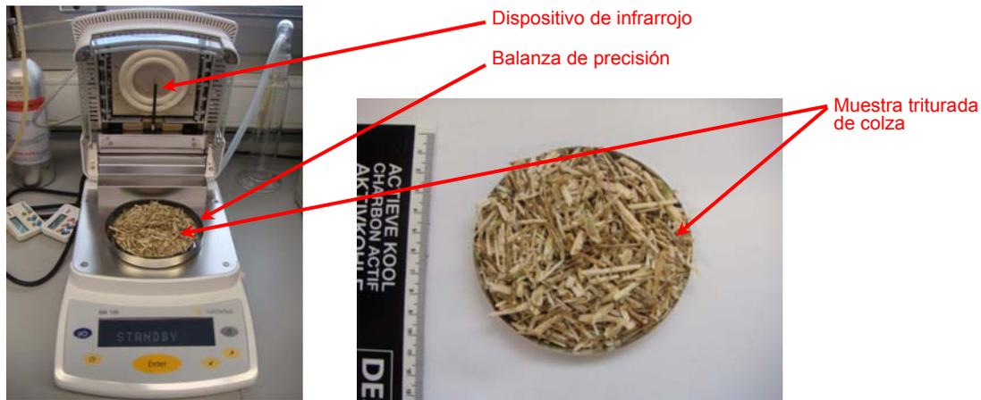
**Figura X.10. Análisis del contenido de humedad de colza mediante Termobalanza (Sartorius Moisture Analyser)**
