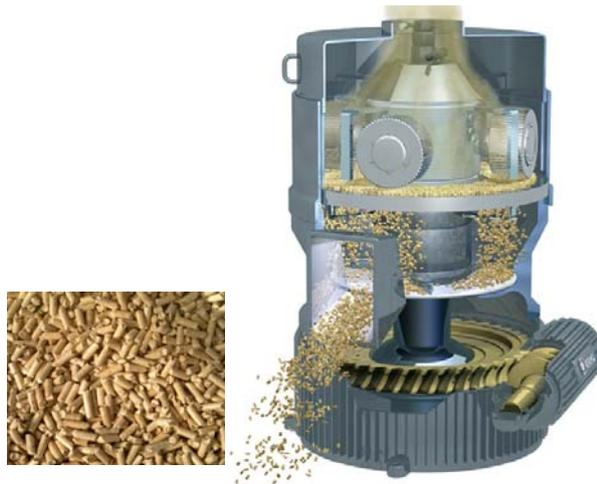
**Figura VII.2. Mecanismo de peletizado.**
