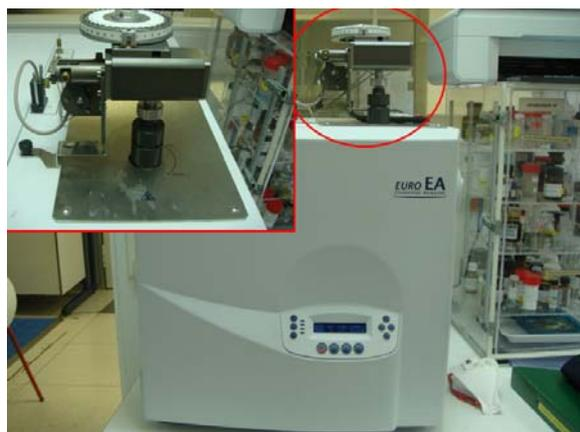
Figura X.3. Analizador elemental (C,H,N y S), EuroEA Elemental Analyzer
