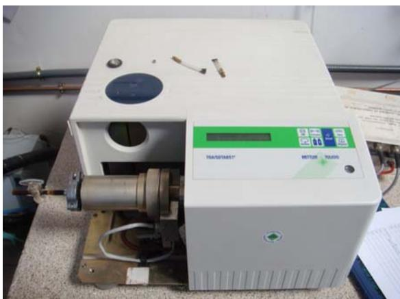
**Figura X.6. Dispositivo TG-DTA Mettler Toledo**
