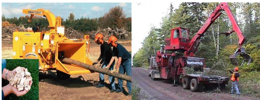
**Figura VII.1. Astilladoras móviles: alimentación manual y mecánica**
