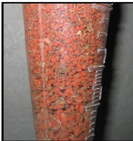
**Figura 4.9** Fotografía de la biomasa granular anammox durante el ensayo realizado.
