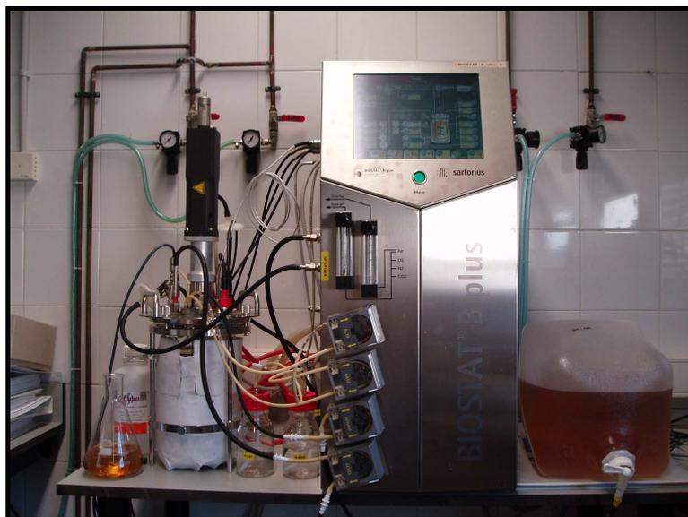
**Figura 3.5** Fotografía fermentador SBR 2L utilizado para el tratamiento de lixiviados.
