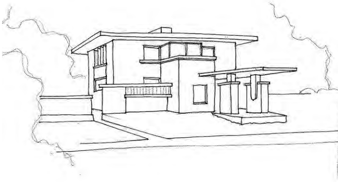
Fig. 2.7.2 Wright propuso en 1901 para la construcción de unas viviendas económicas la utilización del hormigón como material fundamental. Paralelamente, el nuevo material suponía una garantía de resistencia al fuego inusual en las construcciones tradicionales con estructura de madera o de acero.
