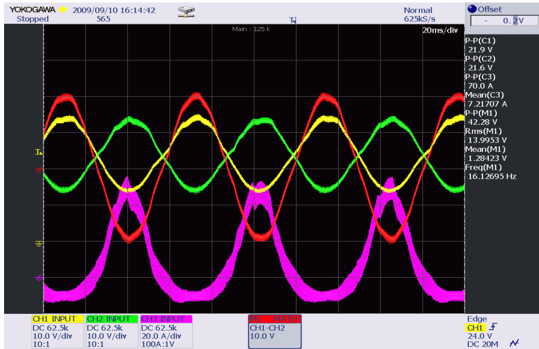
Figura 4.19: Seguimiento Senoidal para el Convertidor DC-AC ( B=20 voltios)
