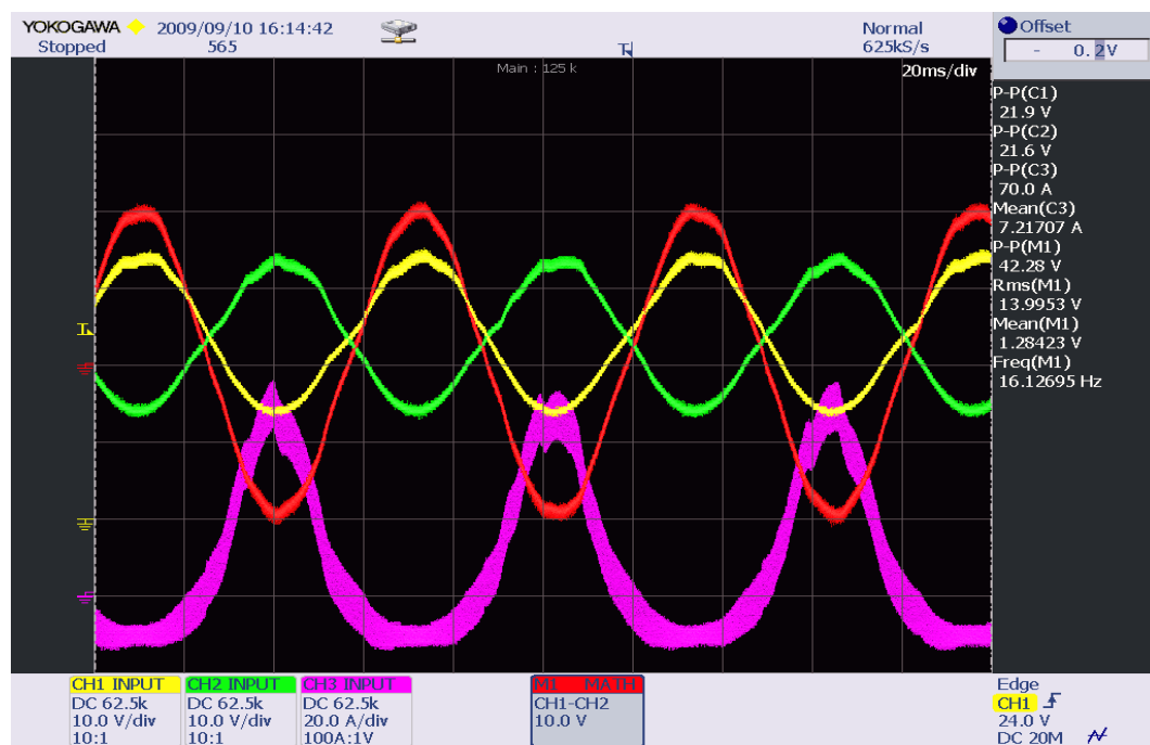
Figura 4.25: Seguimiento Senoidal para el Convertidor DC-AC (B=20 voltios)
