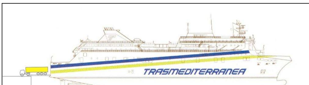
Figura 3-2: Buque con una sola rampa. (Fuente: [www.trasmediterranea.es](http://www.trasmediterranea.es))
