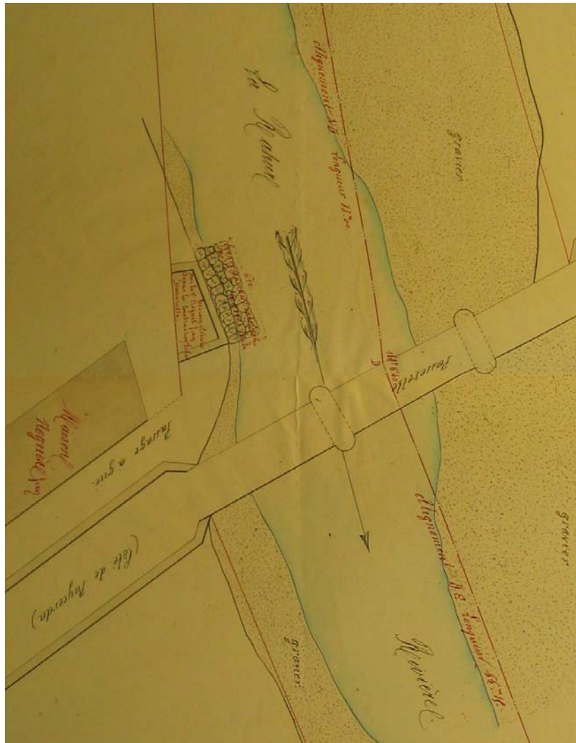
Figura 80. Plan des lieux . Plànol que acompanya l'escrit Constructions d'enrochements par le Sr. Roguès (Jean) de Puycerda , d'u d'octubre de 1866. Tram del Reür que passa sota el pont que connecta Puigcerdà amb la Guingueta d'Ix amb unes obres d'escull a la banda espanyola, destacades en color vermell. Font: AMAEE, Fons Callier – caixa 12.
