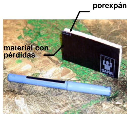
**Figura 3.2** Pantalla detectora. Papel con pérdidas adherido a una base de porexpán.
