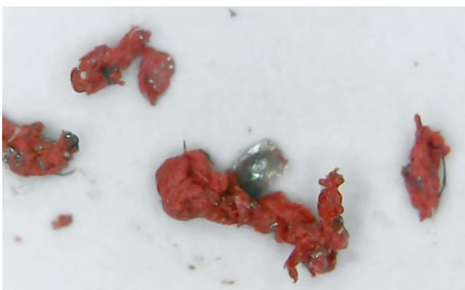
Figura 92. Sèrie de fotografies mitjançant un microscopi digital de la pintura impregnada en els cargols.
