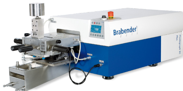
Figura 23. Mezclador de fusión intensivo Brabender Plastograph
