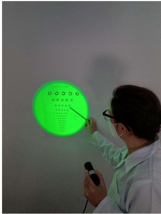
Figura 7.2: Representación de la iluminación de un optotipo con el LED G para la medida de AV.
