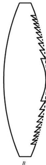
Figura 2.4: Esquema de una lente híbrida refractiva-difractiva.
