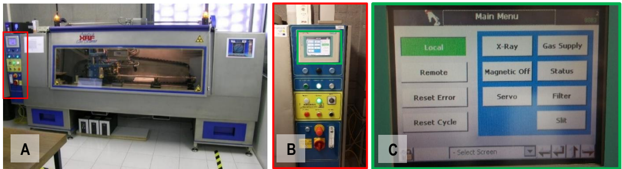
Figura A4.1. (A) XRF core scanner del CORELAB, Universitat de Barcelona. (B) Sección de botones y pantalla de comandos del XRF core scanner. (C) Zoom de la pantalla de comandos.
