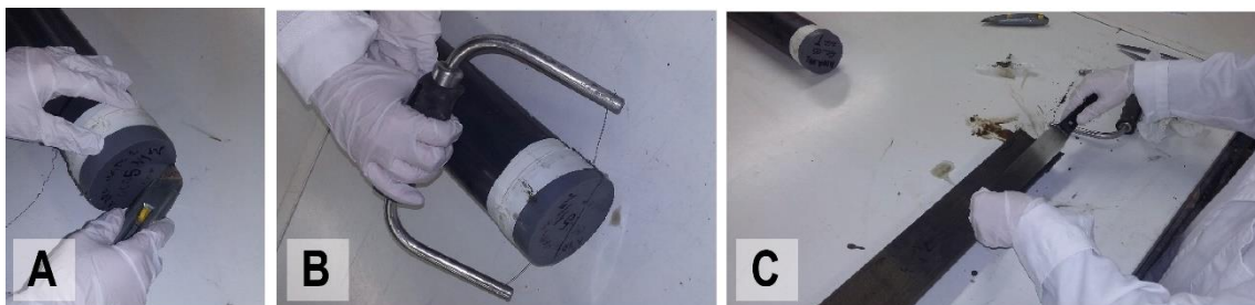
Figura A4.5. (A) Uso del cúter para cortar los tapones por la mitad. (B) Herramienta en forma de arco de carpintero con un hilo de alambre que sirve para separar el sedimento en dos mitades a lo largo del testigo. (C) Alisado de la superficie del testigo.
