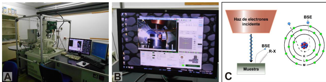
Figura 2.12. (A) Microscopio JEOL J-7100F de los Centres Científics i Tecnològics de la Universitat de Barcelona (CCiTUB) empleado en el análisis de las muestras. (B) Detalle de la colocación de la muestra dentro del equipo. (C) Esquema teórico del principio de funcionamiento del SEM, donde se ilustran algunas de las señales generadas por la interacción del haz primario de electrones con la superficie de la muestra, así como la emisión de electrones después de la incidencia del haz emitido. BSE: electrones retrodispersados. R-X: rayos X.
