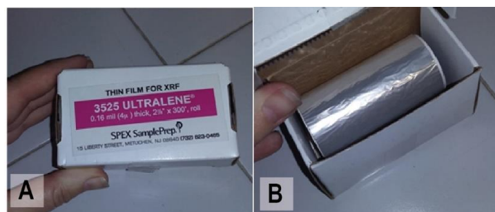
Figura A4.11. (A) Detalle del tipo de film empleado. (B) Rollo de lámina plástica ( film ) especial transparente para el análisis mediante XRF.
