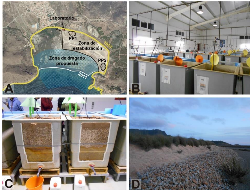
Figura 1.16. (A) Esquema de las actuaciones para la regeneración y adecuación ambiental de la bahía de Portmán, contempladas en el proyecto In Situ . Se indica la localización del laboratorio construido al efecto, de las zonas de dragado y de estabilización, y de las parcelas piloto PP1 y PP2 (adaptado por la autora a partir de paneles informativos del laboratorio de In Situ ). (B) Laboratorio con tanques conteniendo distintos tipos de tecnosoles. (C) Detalle del perfil de dos tecnosoles. (D) Detalle de la parcela piloto PP1, en la que se plantó vegetación local. Fotografías de la autora.
