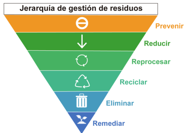
Figura 1.5. Jerarquía de gestión de residuos, adaptado a la gestión de residuos mineros (modificado y adaptado de Lébre y Corder, 2015).
