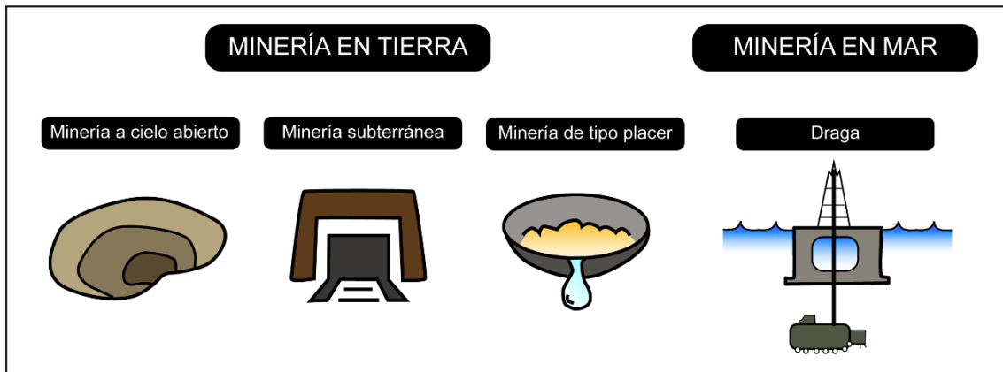
Figura 1.3. Metodologías principales de extracción minera, tanto en tierra, como en el mar (adaptado de Cummins, 2021).
