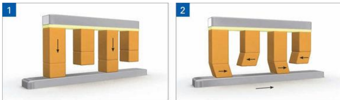
Figura 3.23. Esquema d'un sistema piezowalk. En el primer pas hi ha part del transductor piezoelèctric que fa contacte amb la guia, mentre que en el segon pas es flexiona per tal de produir un desplaçament lateral. Posteriorment s'intercanviarien les parts que s'adhereixen a la guia per repetir el pas 1 i 2 consecutivament. Font: www.physikinstrumente.com .
