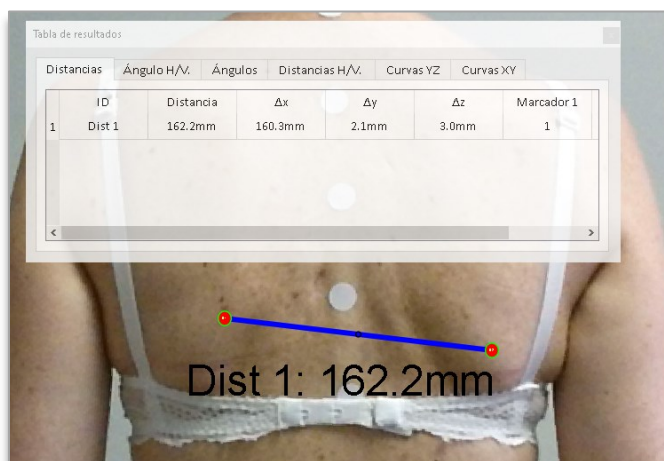
Figura 33. Tabla que muestra los incrementos en XYZ de una distancia entre dos puntos de resultado 162,2 mm.
