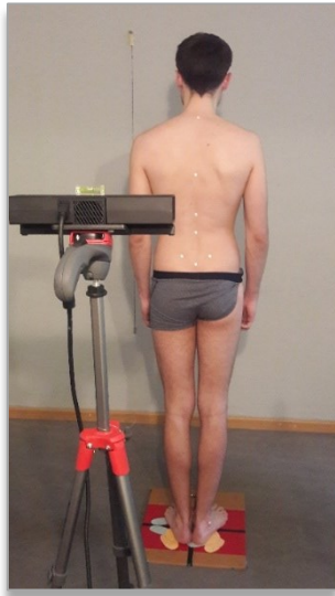
Figura 60. La imagen muestra la posición ortogonal del sensor Kinect respecto al paciente.
