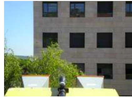
Figura 4-10: Monitoreo RAR del Edificio Omega situado en el Campus Nord de la Universidad Politécnica de Cataluña (Barcelona). Detalle de las tres orientaciones RAR-Edificio, durante la campaña de mediciones
