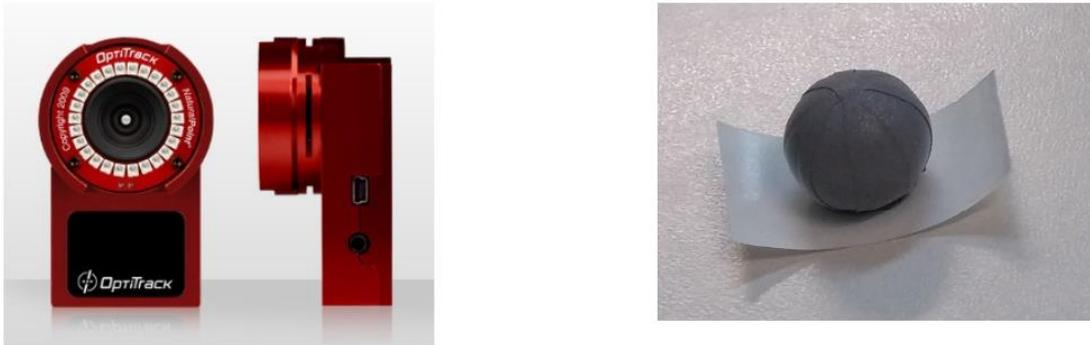
Figura 25: a. cámara usada en el estudio (OptiTrack IR camera). b marcador reflectivo (OptiTrack TM) usado en el estudio.
