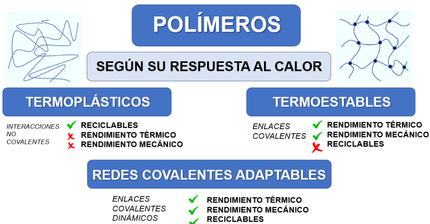
Figura I-1. Clasificación de los materiales poliméricos en función a su respuesta al calor
