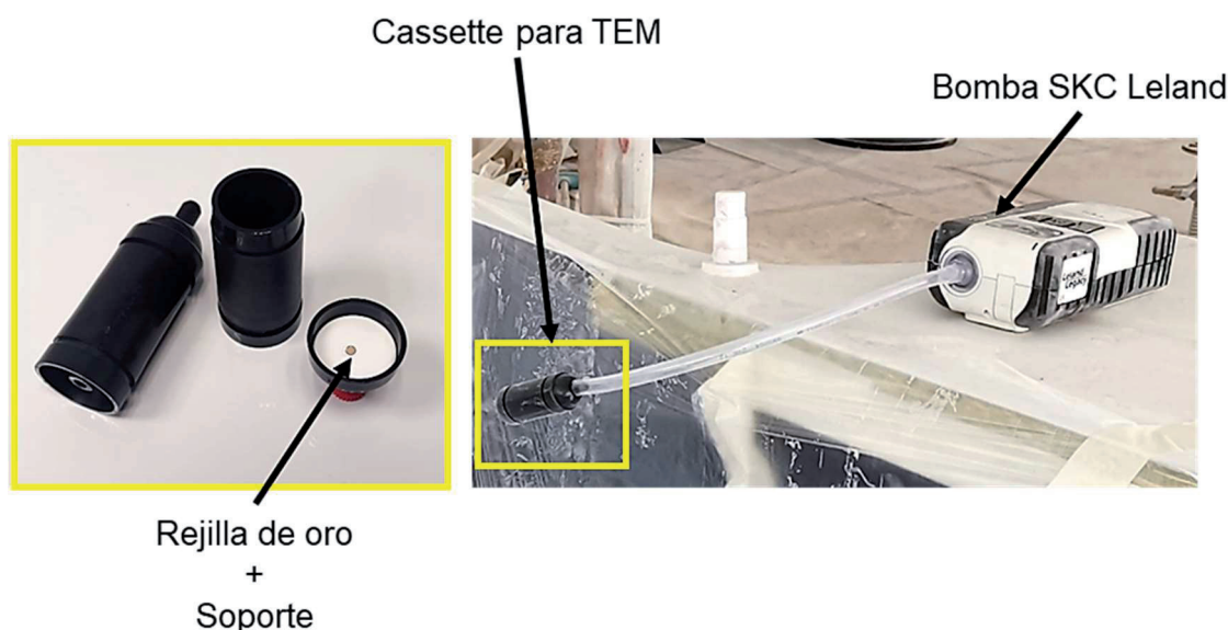
Figura 3.18. Estrategia de muestreo para la recogida de muestras para análisis por microscopía TEM (fuente propia)
