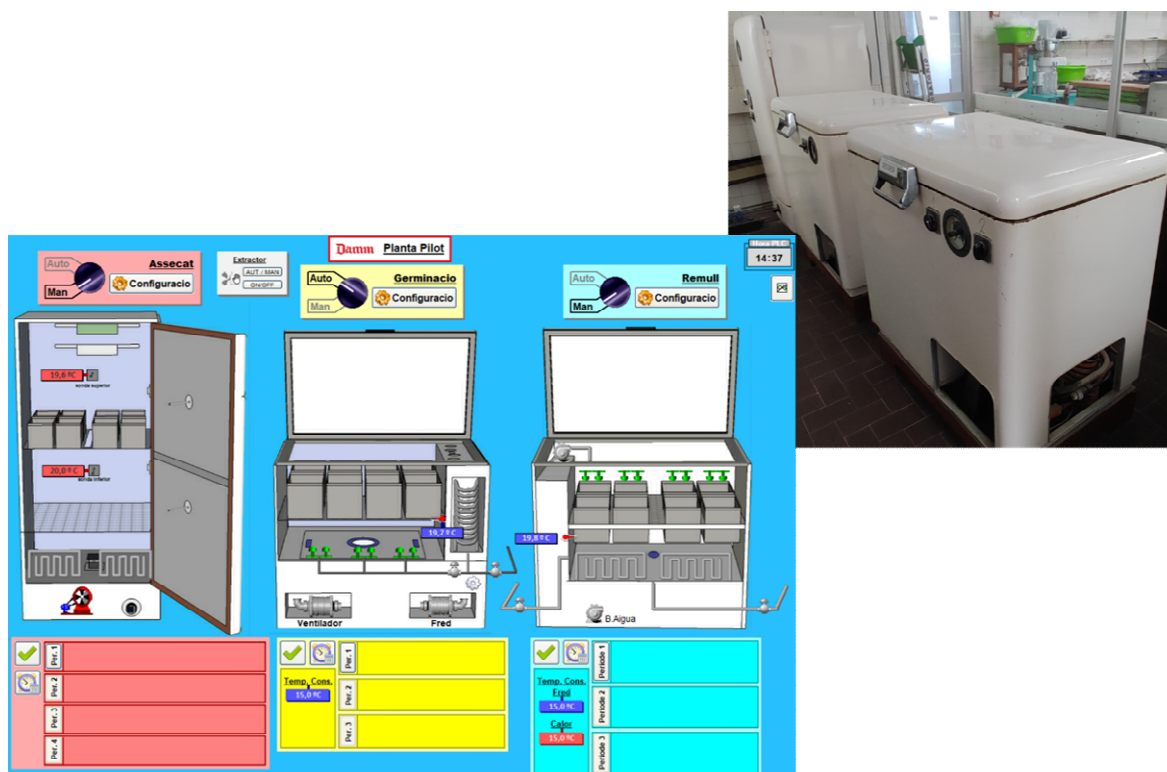
Figura 5.4. Equipo de micro-malteado a escala planta piloto y SCADA de control situada en las instalaciones de la Maltería La Moravia.
