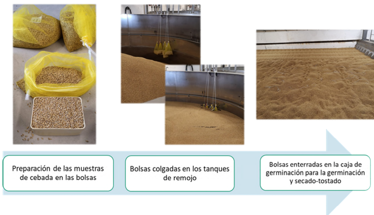
Figura 5.5. Micro-malteado en bolsas de malla en las instalaciones industriales de la Maltería La Moravia.
